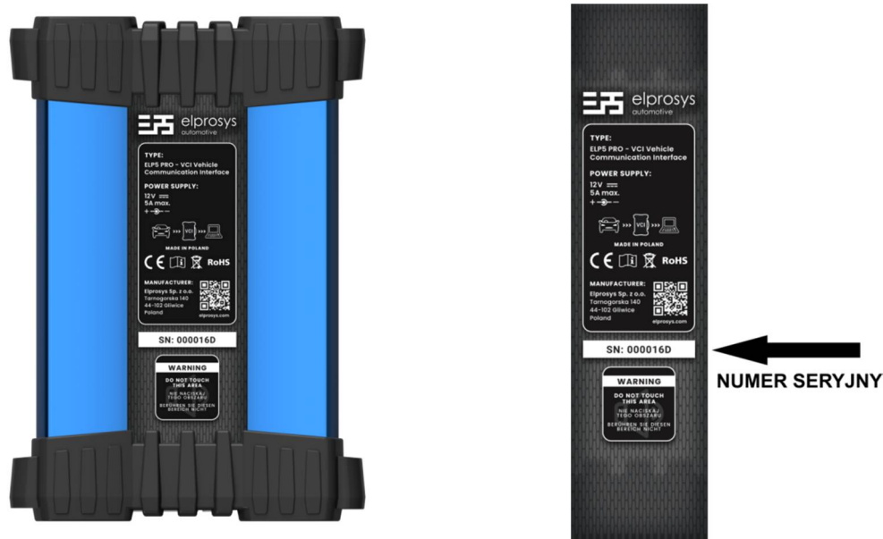
ELP5 PRO – VCI Vehicle Communication Interface – Tabliczka znamionowa z numerem seryjnym. Numer seryjny odczytany z tabliczki, widocznej na powyższym rysunku, to "000016D"
